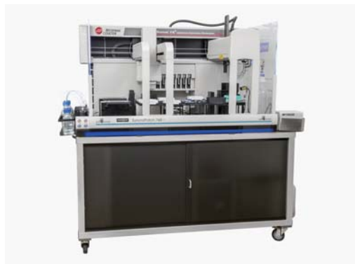
ハイスループット・自動パッチクランプ装置 (iPS細胞由来心筋細胞の膜電流測定、活動電位測定の384ch同時測定を実現)
